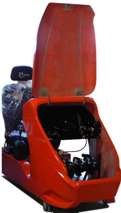
Un capot relevable permet un accès facilité aux équipements.
