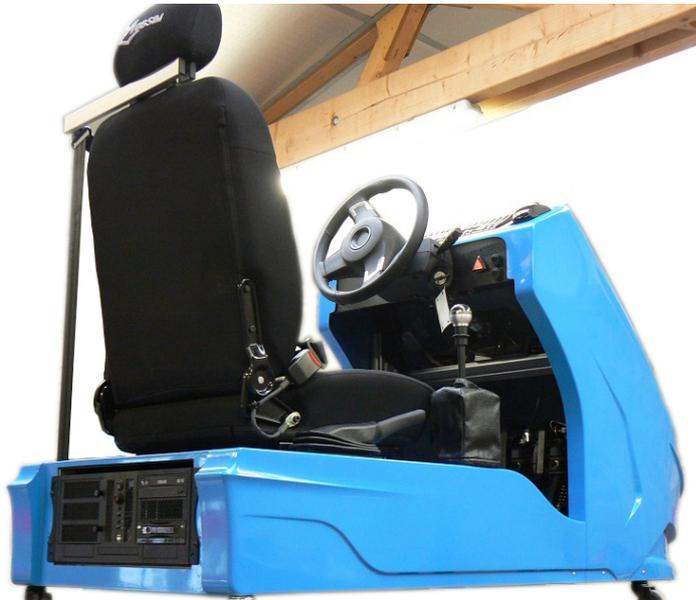
Le PC est implanté sous le siège conducteur permet ainsi l'intégration total des équipements.
