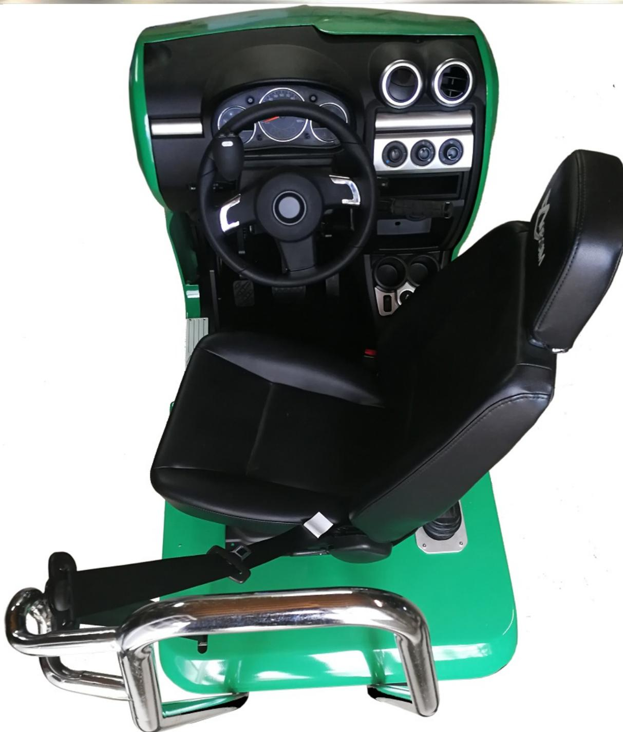
Un arceau Chromé à l'AR du siège, maintient le passant de ceinture et facilite la préhension pour le déplacement du poste.
