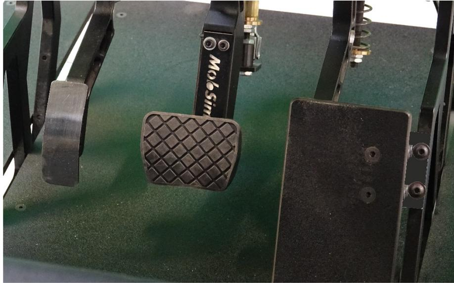
Pédalier facilement commutable avec accélérateur à Gauche. Dans ce cas un repose pied est prévu pour la jambe droite
