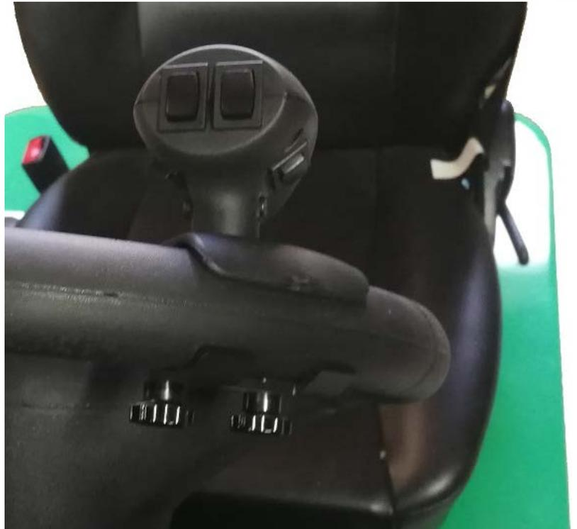
Levier de vitesse MobSim à 6 vitesses + M.AR : reproduit fidèlement les débattements, et efforts d'une commande de boîte de vitesse. Une bague sous le pommeau se soulève pour déverrouiller la M.AR.
